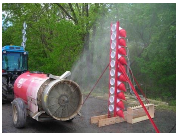
Εικόνα 21: Κινητός πίνακας – τράπεζα μέτρησης ομοιομορφίας κάθετης κατανομής
