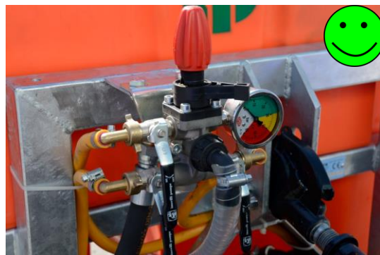
Εικόνα 48: Αναλογικό μανόμετρο τοποθετημένο σε θέση που επιτρέπεται η ανάγνωση του από τον χειριστή.
