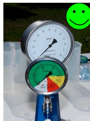
Εικόνα 88: Έλεγχος του μανομέτρου με μανόμετρο ακριβείας
