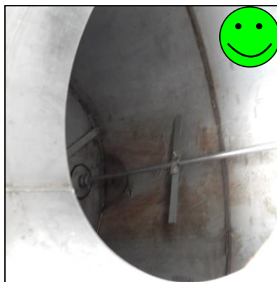
Εικόνα 35: Μηχανισμός μηχανικής ανάδευσης
