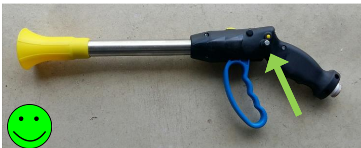
Εικόνα 71: Πέκκα χειρός με μηχανισμό «κλειδώματος» της σκανδάλης
