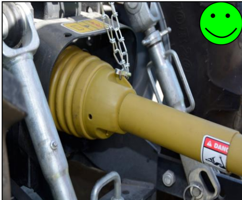
Εικόνα 24: Άξονας μετάδοσης κίνησης με προστατευτικό κάλυμμα και αλυσίδα
