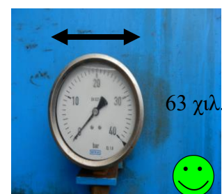
Εικόνα 89: Η ελάχιστη διάμετρος του μανομέτρου πρέπει να είναι 63 χιλιοστά
