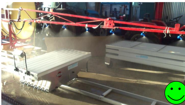
Εικόνα 68: Πρότυπος ηλεκτρονικός μετρητής οριζόντιας κατανομής
