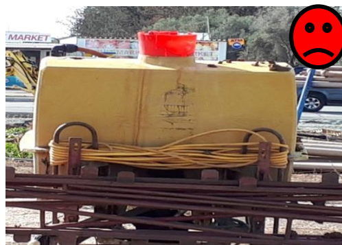
Εικόνα 37: Βυτίο με ακατάλληλο πώμα
