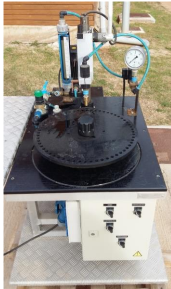
Εικόνα 12: Τράπεζα ελέγχου ροής ακροφυσίων
