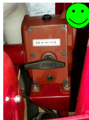
Εικόνα 69: Κιβώτιο ταχυτήτων για διακοπή της λειτουργίας του ανεμιστήρα
