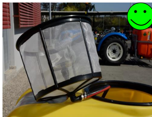
Εικόνα 38: Κατάλληλο και καθαρό πλέγμα
