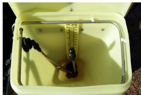
Εικόνα 80: Μηχανισμός ξεπλύματος κενών συσκευασιών Φ.Π.
