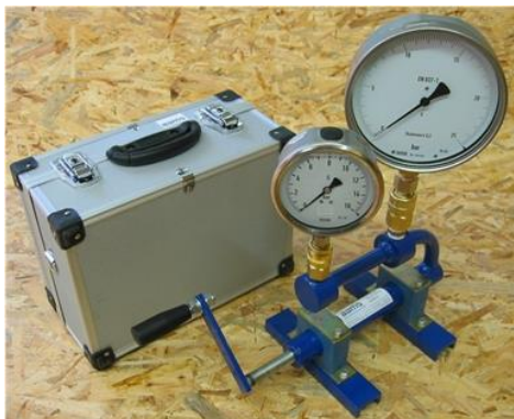
Εικόνα 4 & 5: Πρότυπες πιστοποιημένες συσκευές ελέγχου μανομέτρων – Manometer Testers
