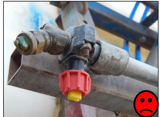
Εικόνα 67: Ακροφύσια που δεν φέρουν αντισταλαγμική συσκευή και η στάλαξη θα συνεχίζεται και μετά το πέρας των πέντε δευτερολέπτων
