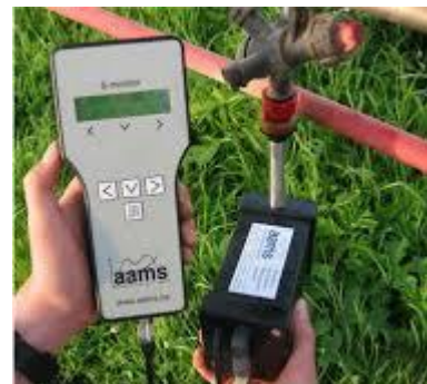
Εικόνες 10 & 11: Ηλεκτρονικός Μετρητής Ροής (Electronic Flow Meter)
