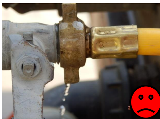
Εικόνα 31: Στατική διαρροή από σωλήνωση
