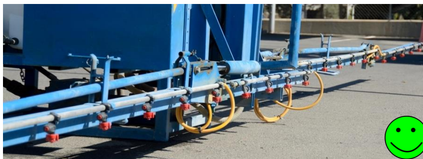
Εικόνα 60: Ομοιόμορφη απόσταση ακροφυσίων και ίδιος προσανατολισμός
