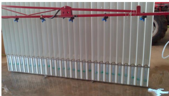
Εικόνα 18: Κινητός πίνακας – τράπεζα μέτρησης ομοιομορφίας της οριζόντιας κατανομής
