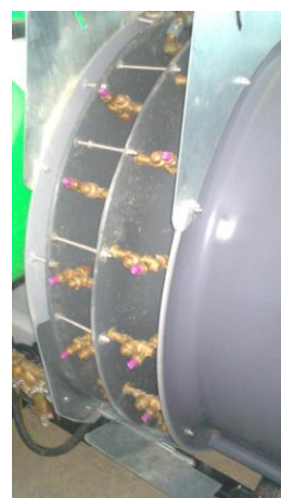
Εικόνα 94: Ακροφύσια ίδιου τύπου, παροχής, υλικού, του ίδιου κατασκευαστή
