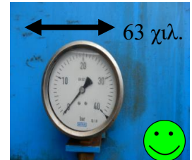
Εικόνα 51: Η ελάχιστη διάμετρος του μανομέτρου πρέπει να είναι 63 χιλιοστά
