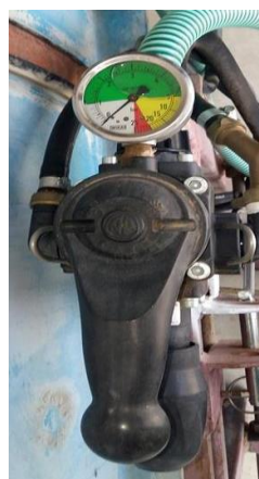
Εικόνα 47: Χειροκίνητο χειριστήριο ψεκασμού
