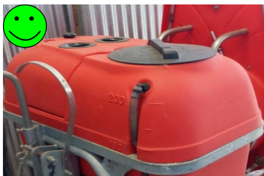
Εικόνα 36: Βυτίο με κατάλληλο πώμα
