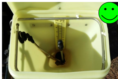
Εικόνα 44: Μηχανισμός ξεπλύματος κενών συσκευασιών ΦΠ
