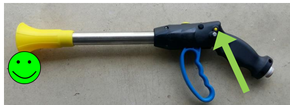
Εικόνα 97: Πέκκα χειρός με μηχανισμό «κλειδώματος» της σκανδάλης
