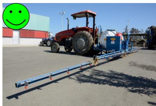
Εικόνα 59: Σταθερότητα και ευθυγράμμιση τμημάτων ψεκασμού
