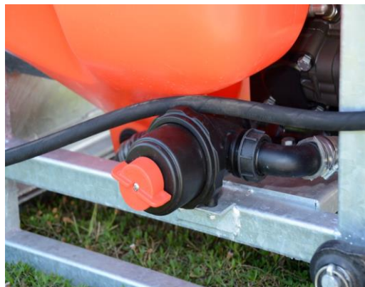
Εικόνα 92: Το κυρίως φίλτρο, το οποίο είναι τοποθετημένο μεταξύ του βυτίου και της αντλίας
