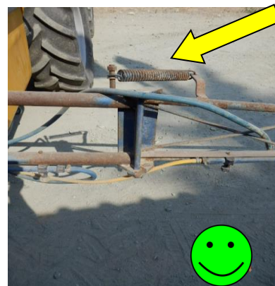
Εικόνα 64: Μηχανισμός αντιστάθμισης κλίσης μπάρας ψεκασμού
