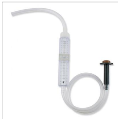
Εικόνα 13: Φορητός Μετρητής Ροής Ακροφυσίων
