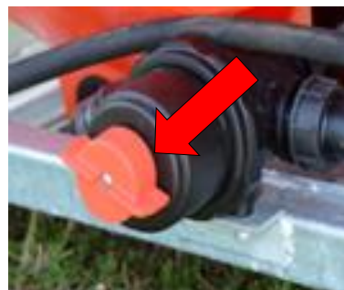
Εικόνα 56: Συσκευή απομόνωσης του κυρίως φίλτρου
