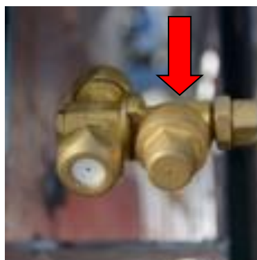
Εικόνα 95: Σώμα ακροφυσίων με αντισταλαγμικό μηχανισμό που δεν επιτρέπει τη στάλαξη μετά από πάροδο 5 δευτερολέπτων
