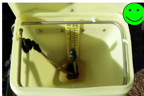
Εικόνα 41: Μηχανισμός ξεπλύματος κενών συσκευασιών Φ.Π.
