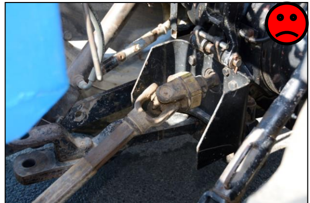
Εικόνα 25: Άξονας μετάδοσης κίνησης χωρίς προστατευτικό κάλυμμα και αλυσίδα
