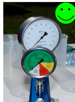
Εικόνα 50: Έλεγχος του μανομέτρου με μανόμετρο ακριβείας
