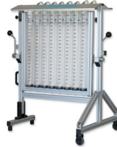
Εικόνα 9: Ογκομετρικοί σωλήνες σε πλαίσιο.
