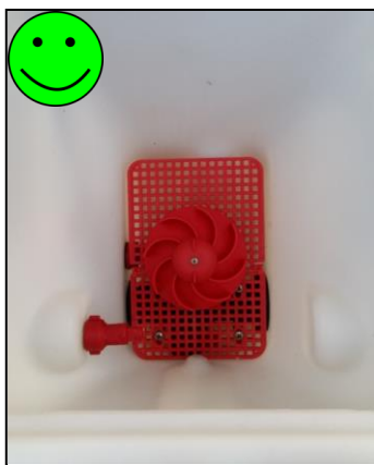
Εικόνα 40: Μηχανισμός ανάμιξης και διάλυσης των Φ.Π.
