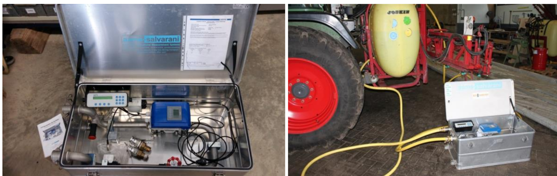
Εικόνα 22 & 23: Συσκευή μέτρησης της ισχύος της αντλίας.
