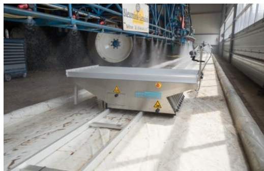
Εικόνα 19: Ηλεκτρονική τράπεζα μέτρησης ομοιομορφίας οριζόντιας κατανομής
