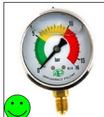
Εικόνα 49: Αναλογικό μανόμετρο με τις διαβαθμίσεις ανά 0,2 ατμ
