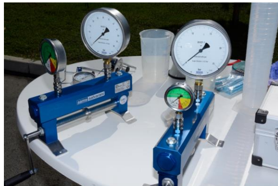
Εικόνα 4 & 5: Πρότυπες πιστοποιημένες συσκευές ελέγχου μανομέτρων – Manometer Testers
